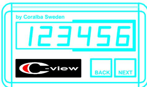
C-giant è disponibile anche con un connettore di comunicazione dove è possibile collegare un display aggiuntivo per il pilota (C-view), un allarme che indica il superamento di una velocità preimpostata, un computer od una stampante nella combinazione che si desidera.
